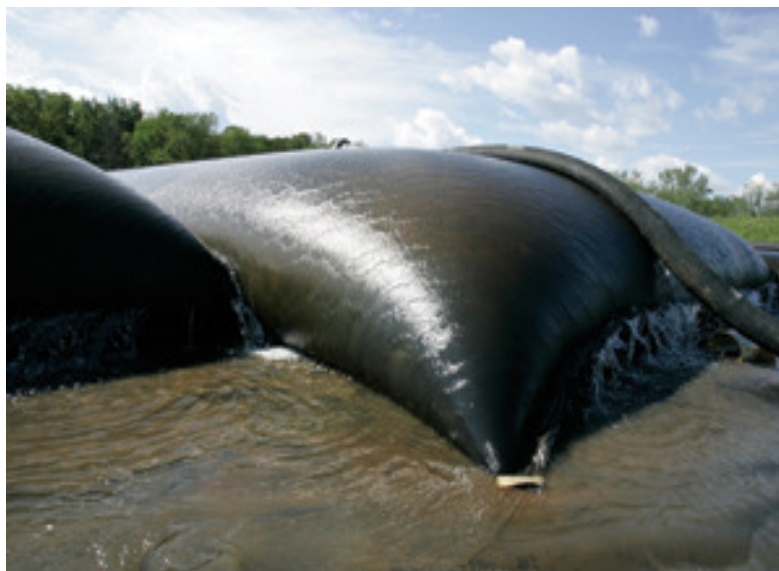
Figura 3.10 - Percolação de água através das paredes do "geotube". Fonte: www.geotube.com
