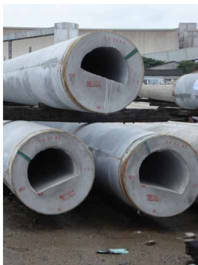
Figura 9.11 - Seção da estaca SCAC após a centrifugação. Fonte: Visita à Santos Brasil realizada em 30 de Abril de 2008.
